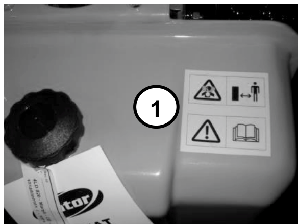
[1] Pe rezervorul de combustibil: Gaz de evacuare, Mențineți distanța, Pericol, Citiți manualul.
