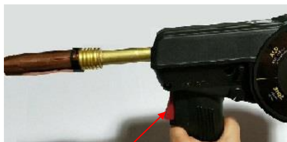
(12) Apăsăți trăgaciul pentru a conduce firul în josul gâtului până când acesta iese din vârful de contact.
