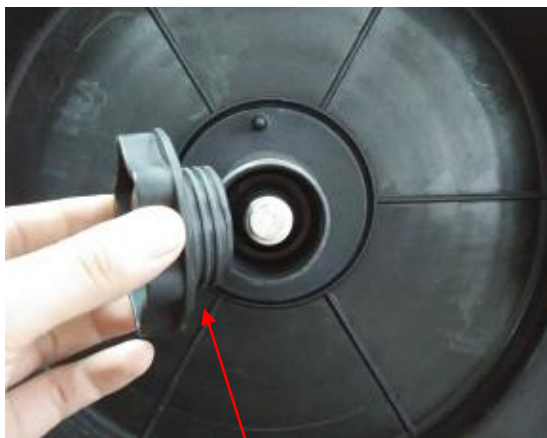
(1) Îndepărtați piulița de fixare a bobinei.
