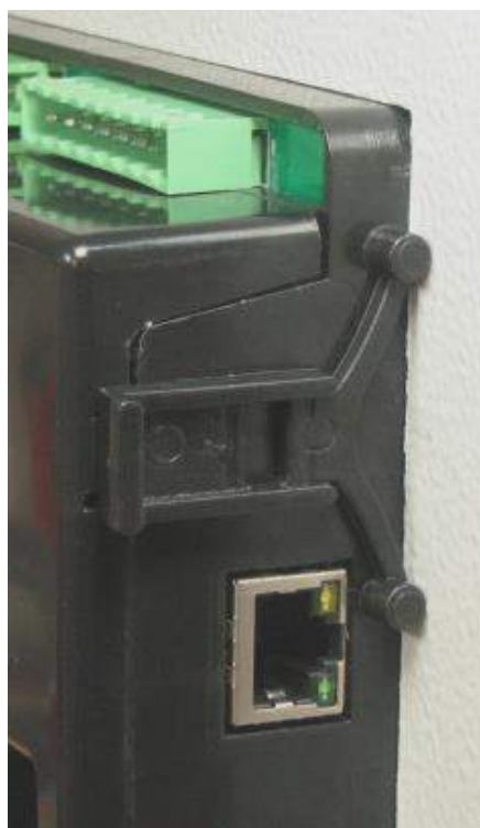
Instalarea suportului cu auto-blocare
