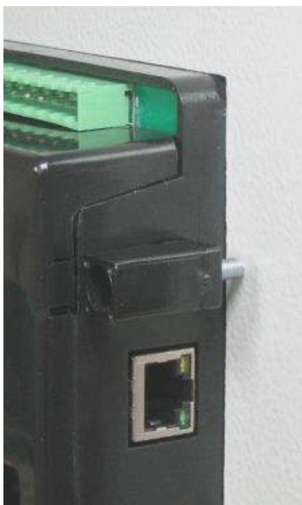
Instalarea suportului tip șurub
